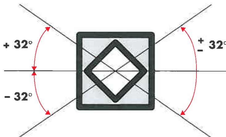
Das Gummifederelement besticht durch seine einfache, kompakte Bauweise. Die eingefügten Gummikörper auf Naturkautschukbasis erlauben einen grossen Arbeitsverdrehwinkel von  $\pm 32^\circ$ . Die Drehfrequenz ist vom Arbeitsverdrehwinkel abhängig. Das verwendete Gummimaterial ergibt im Drehbereich von  $0^\circ - 32^\circ$  eine progressive Federkennlinie.
